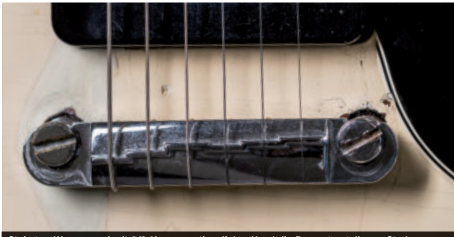
Stairstep-Wraparound mit 3/3-Kompensation, linker Hand die Reparaturstelle am Stud
